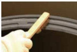
4. 新しいガスケットセメントを溝に充填します。
