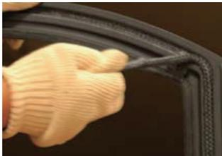
3. 端についているガスケットセメントやガスケットの繊維を、マイナスドライバー等で取り除きます。ガスケットセメントを取り切れない場合は、ワイヤーブラシやサンドペーパーで溝をならします。細かいホコリ等はウェスで拭き取ります。
